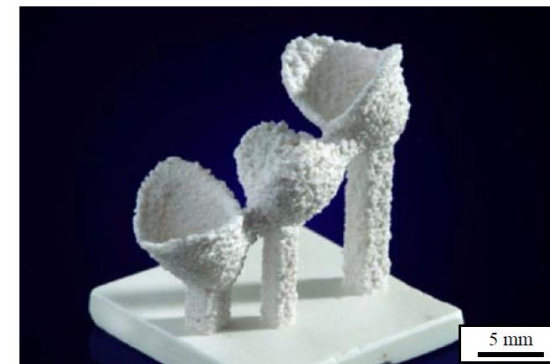
Yttriem stabilizovaná keramika na bázi zirkonu zpracovaná SLM za teploty předehřevu 1670 °C (Liu, 2015)
