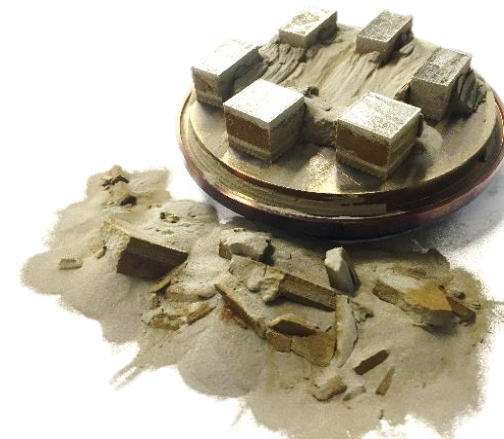
Degradace titanového prášku při předehřevu 550 °C
